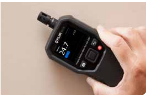
Controleer vochniveau met pinloze metingen
